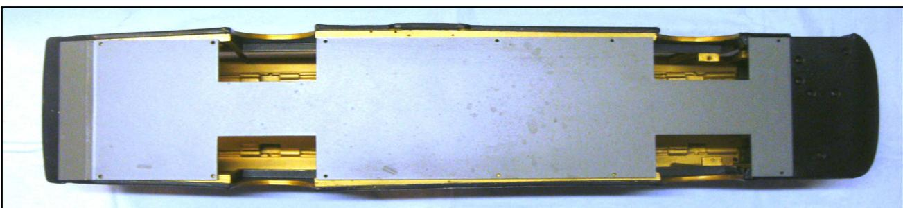
*Die gerade Bodenplatte und die krumme Karosserie-Linie klaffen bis zu 16 mm weit auseinander! Beim Vergleich mit dem grundierten Bild von Streich 14 fällt die verstärkte Krümmung ebenfalls auf. Man erkennt auch den Längsverzug besonders im Heckbereich. Zur Bestandsaufnahme habe ich eine Menge Fotos gemacht.*
