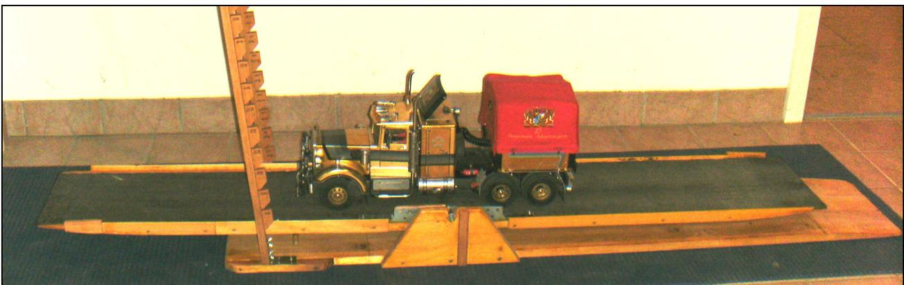
*Die Wippe jetzt umgebaut und kombiniert mit Steigungsfähigkeits-Messung.*
