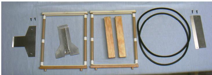
*Das T-förmige Hakenblech in der Mitte dient zum Heben ohne die beiden äußeren Bleche. Die dicken O-Ringe sind zum Wenden des Modelles gedacht.*
