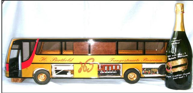
*Nachdem **kurz vor Weihnachten** die Verdrahtung des Innenlebens fertig, sprich sämtliche Beleuchtungs - LED's und die Servo- Ansteuerung für die Türen angeschlossen waren, schon mal den Bus-Himmel montiert.*
