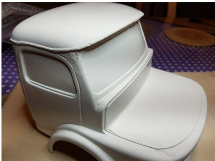
Das sah nach viel Arbeit aus. Alles musste ausgeschnitten werden, Fenster und Kotflügel sowie der Motorraum denn da sollte ja die Elektronik und der Akku rein. Also erstmal schleifen und spachteln. Nach einem Monat war dann das Führerhaus fertig zum Lackieren.
