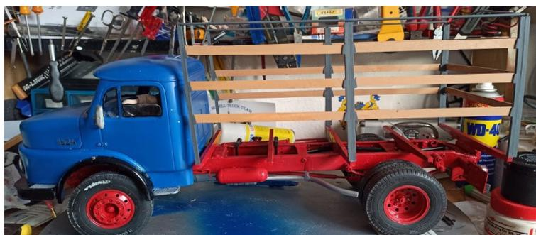
Nach etlichen Fehlversuchen Stirn- und Bordwände aus Kunststoff zu fräsen oder zu drucken, entschloss ich mich diese im Original zu bauen. Erstmal 3x3 mm Messing U Profile und 10 Meter Kieferleisten 2x10mm bestellt. Da die Abstände zwischen den Spiegelhaltern 150 mm sind, mussten die Bordwände 150 mm lang und 40 mm hoch
