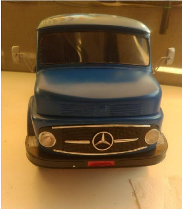
Nur waren die Reflektoren matt. Mal wieder im Internet suchen, nach Reflektoren. Zwei Stück gefunden mit 14 mm Durchmesser. Als Rückleuchten kamen runde Dreikammerleuchten dran. Ins Rücklicht, Bremslicht und Blinker wurden jeweils 0,4 mm SMD`s verbaut. Als Halter für die Rücklichter und dem Nummernschild wurden die vom Scania verbaut.
